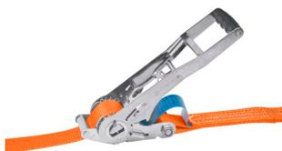
Le tendeur à cliquet ou ratchet ERGO (levier long) tendu par un mouvement de traction, permet de réaliser un plus grand effort de force (les systèmes standard sont avec un cliquet à poussée). Grâce à la force de pré-tension élevée Stf de 500 daN, moins de sangles d'arrimage sont nécessaires pour arrimer une même charge.
