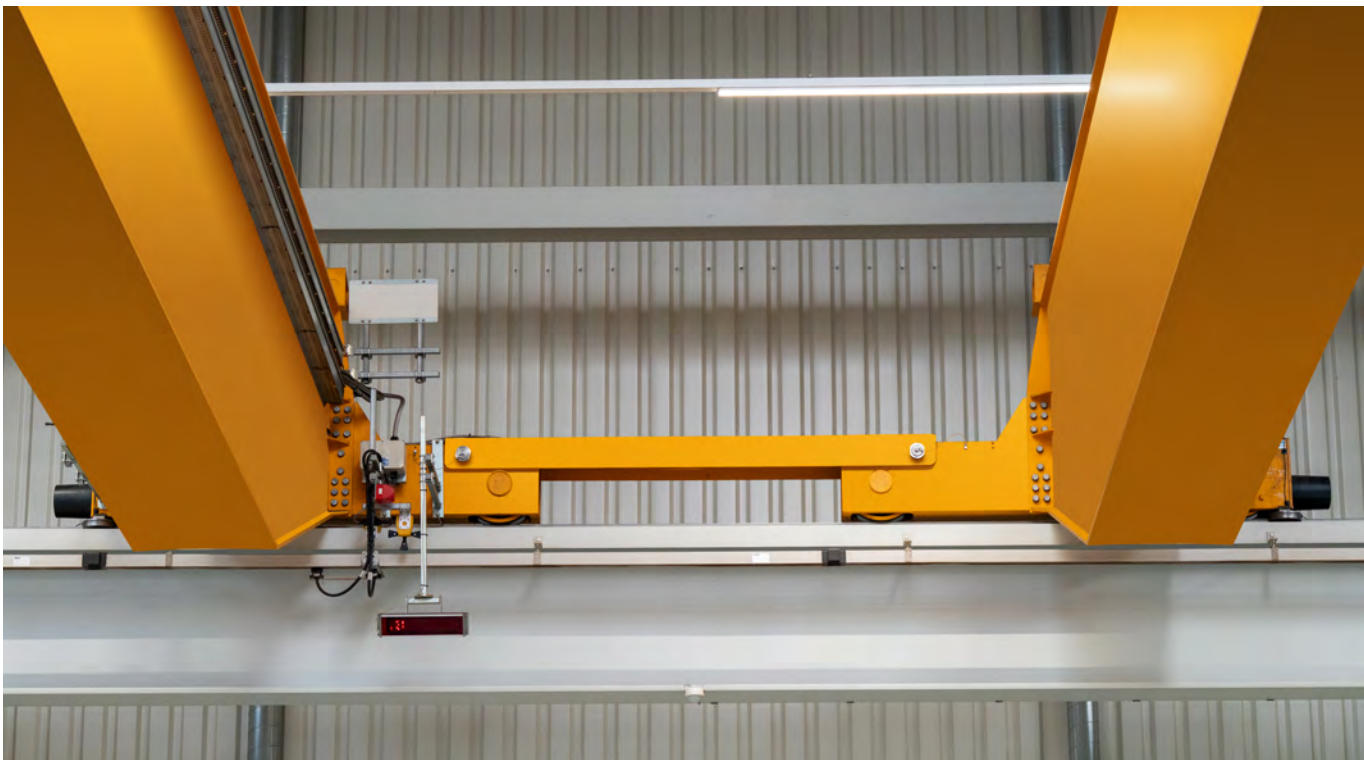
L'utilisation de 2 sommiers couplés formant bogies, reposants sur 8 galets, permet une répartition optimale des charges verticales par galet. Cela signifie par exemple, que pour un chemin de roulement existant, on peut soulever des charges plus importantes, sans avoir à renforcer le chemin de roulement
