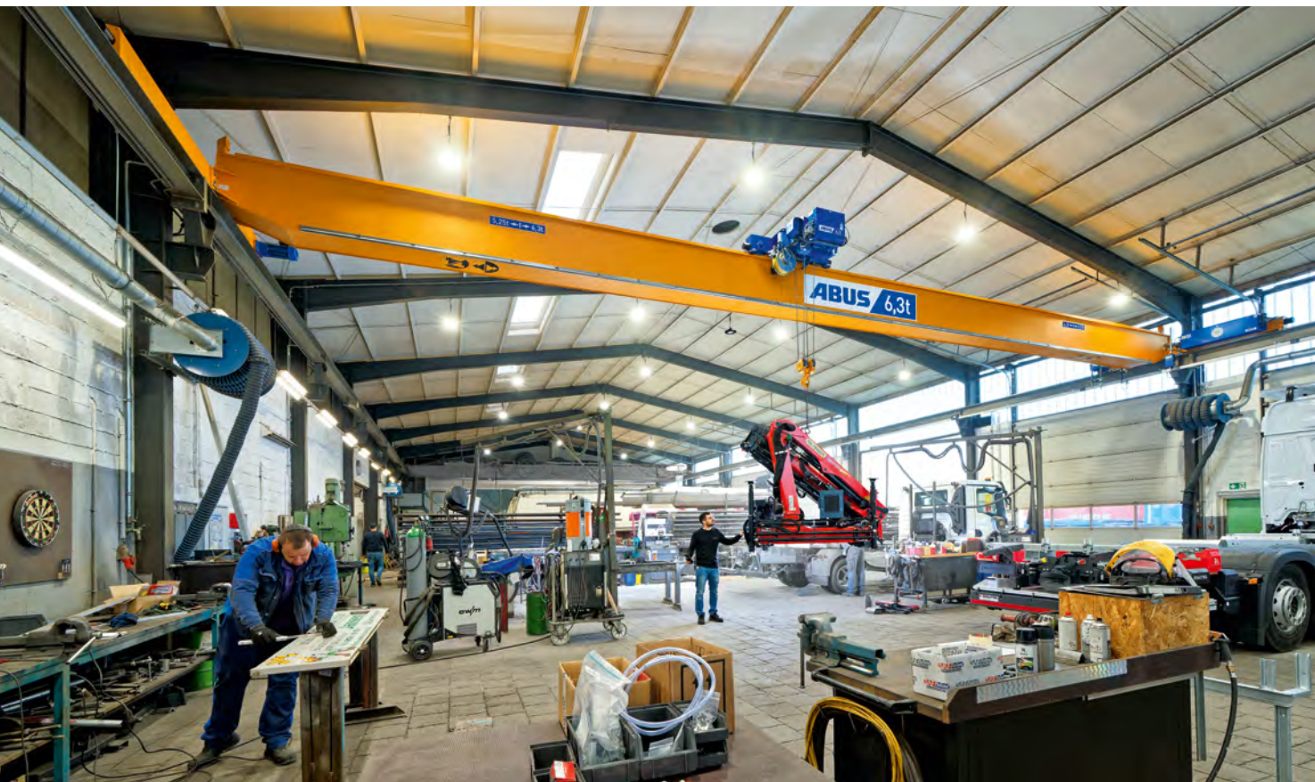
Pont roulant monopoutre avec chariot treuil cavalier, poutre type caisson soudé et jonction de poutre principale standard en variante 3
