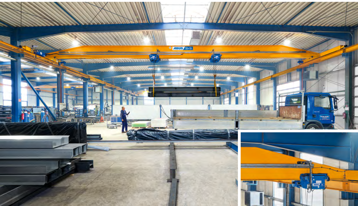
Ponts roulants monopoutres avec poutre type caisson soudé et jonction de poutre principale standard en variante 3. La solution idéale pour bâtiments neufs : le pont roulant monopoutre ABUS type ELK avec pans coupés adapté à la charpente. Cela permet d'exploiter au maximum la hauteur disponible du bâtiment (réalisable également avec le pont roulant monopoutre type ELV à poutre en profilé laminé).
