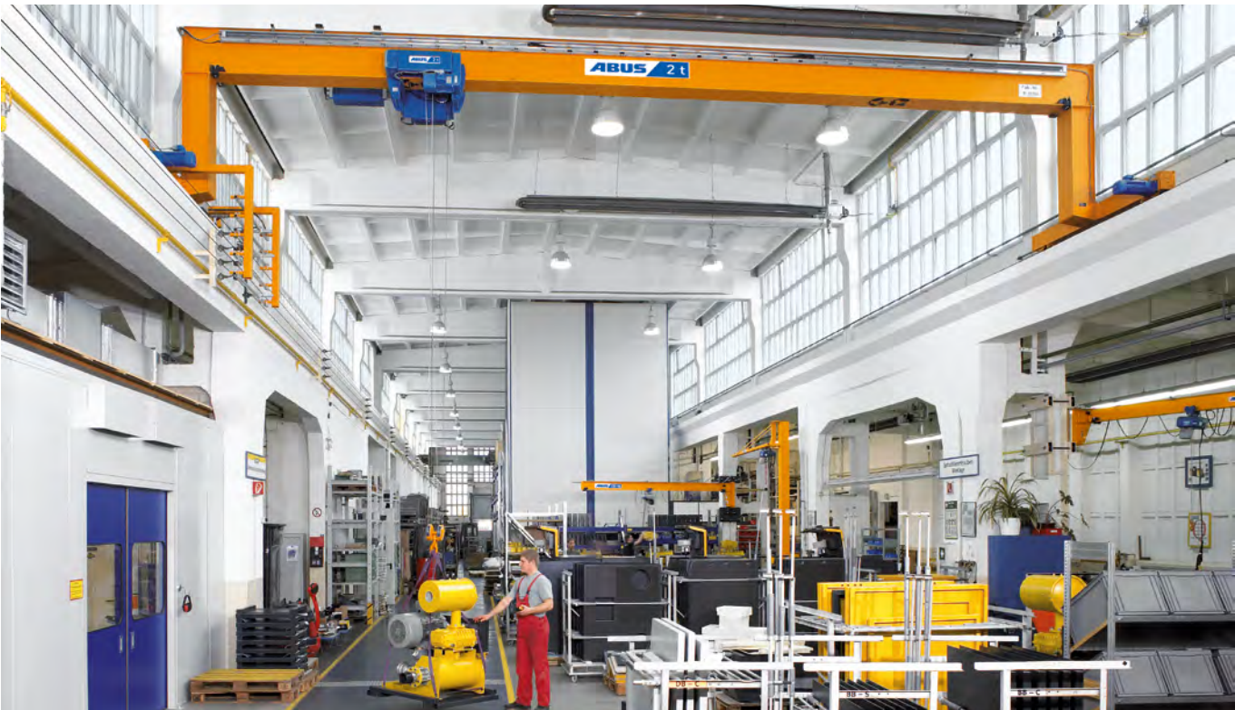
Pont roulant monopoutre ABUS type ELK avec une jonction de poutre principale surélevée en variante 5. Dans certaines configurations architecturales particulières et en cas de contraintes liées à la construction, les poutres principales surélevées offrent des solutions de montage optimisées (cette solution est également réalisable avec le pont roulant monopoutre type ELV équipé d'une poutre en profilé laminé).
