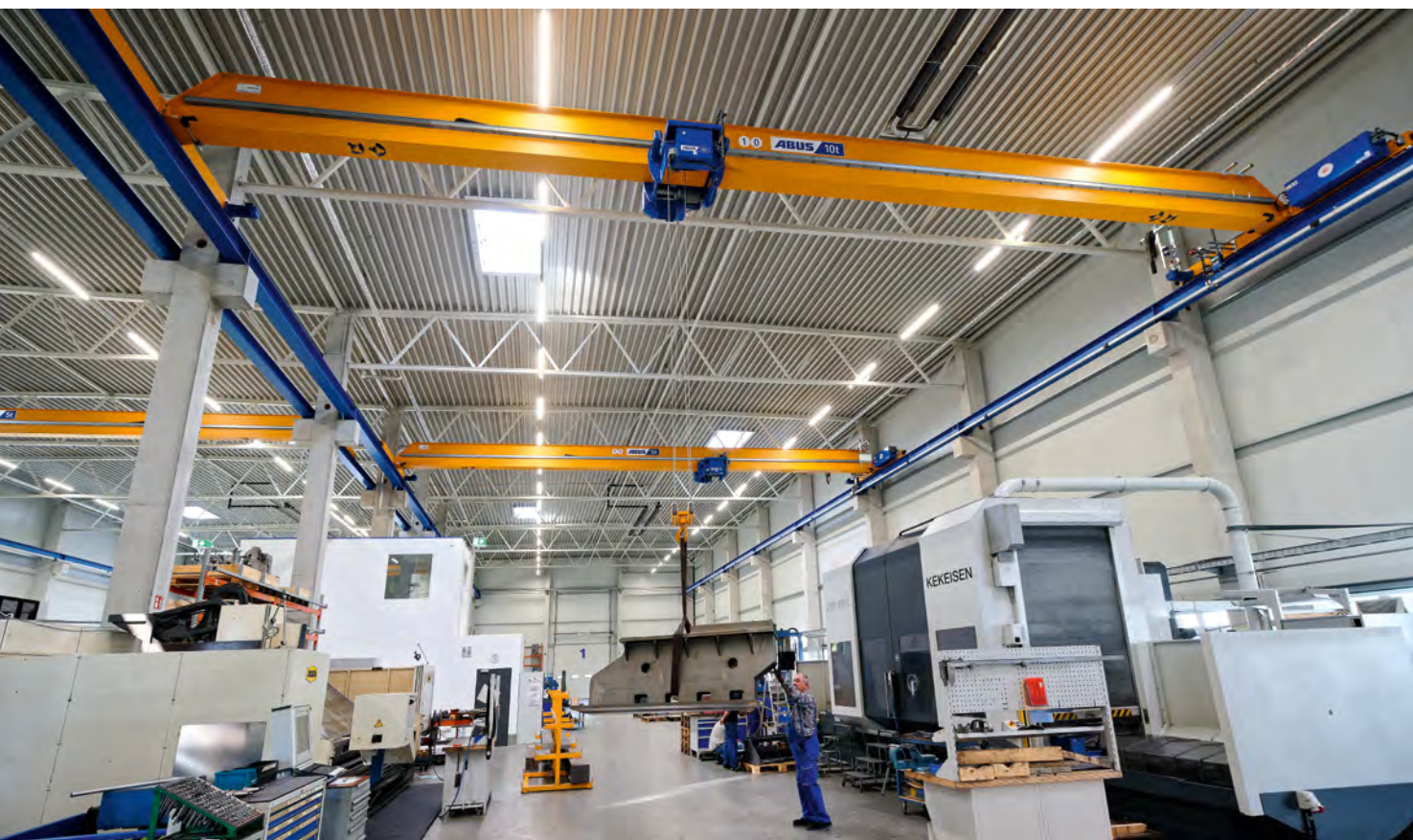
Ponts roulants monopoutres avec poutre type caisson soudé et jonction de poutre principale standard en variante 3
