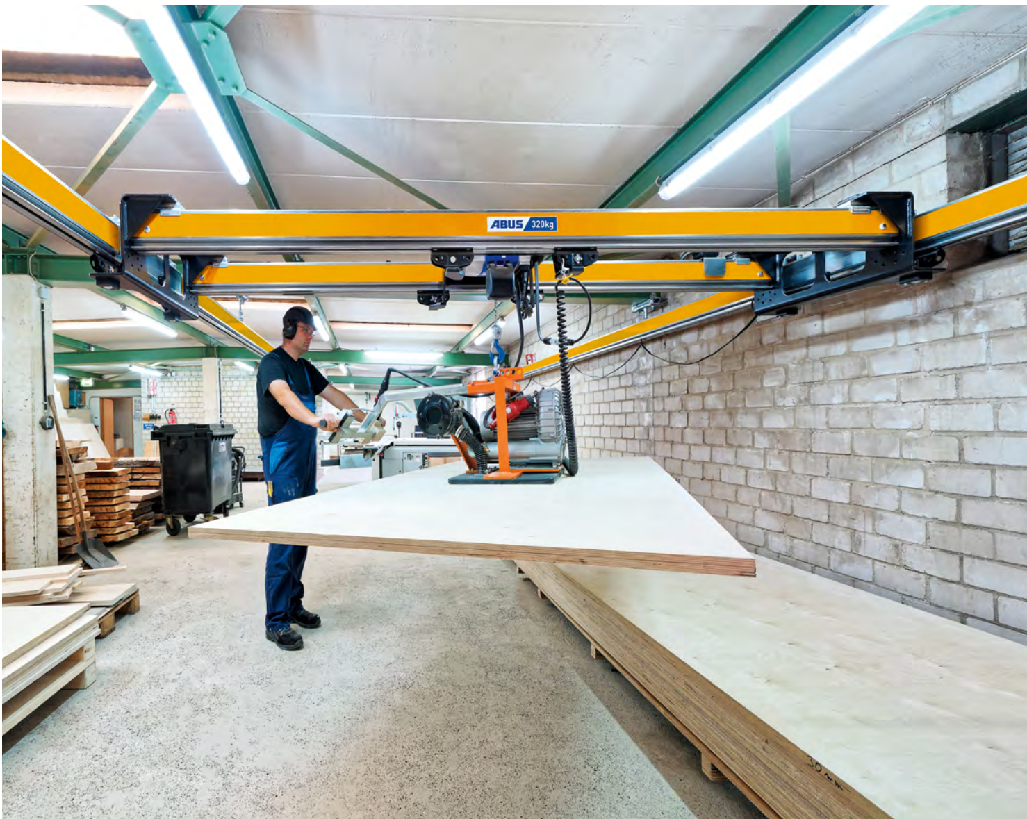
Fixation sur profilé laminé à l'aide de ferrures et préparation pour palonnier
